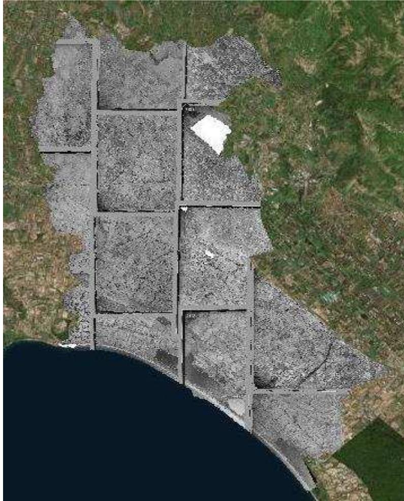
Fig. 111. Mosaico derivante dalle 14 foto aeree georeferenziate. Fonte: elaborazione dell'Autore in ArcMap.
