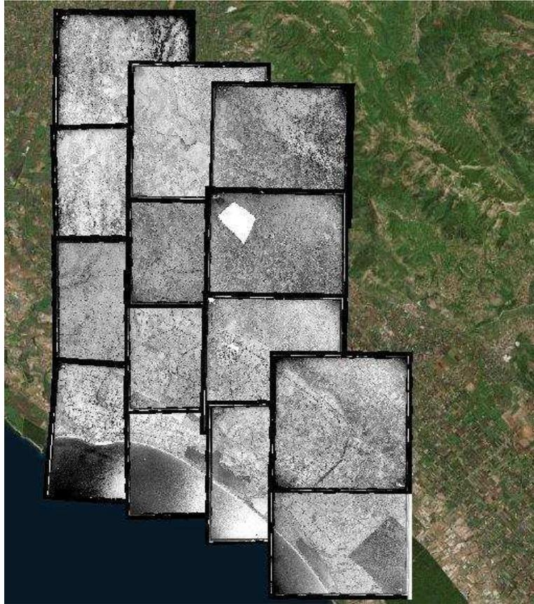
Fig. 109. Georeferenziazione delle 14 foto aeree del 1954. Fonte: elaborazione dell'Autore in ArcMap.
